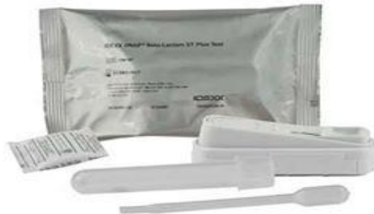
Figure N°3 . Test IDEXX SNAP duo ST plus pour la détection des \beta -lactames, des Tétracyclines et des céfalexine ( www. Idexx.com ).
