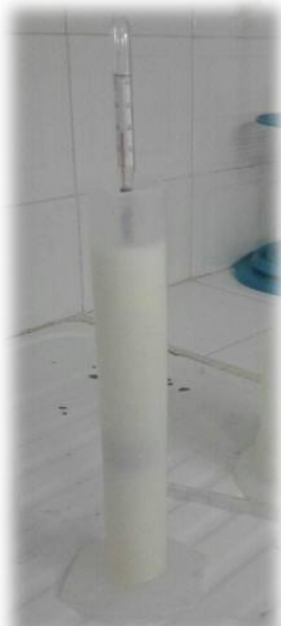
Photo 07: Mesure de la densité par Lactodensimètre (Ph : personnel)
