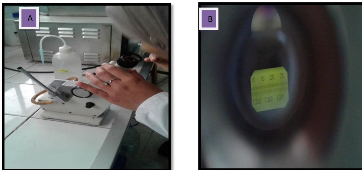
Figure 17 : Mesure de conductivité électrique et degré de Brix par réfractomètre.
