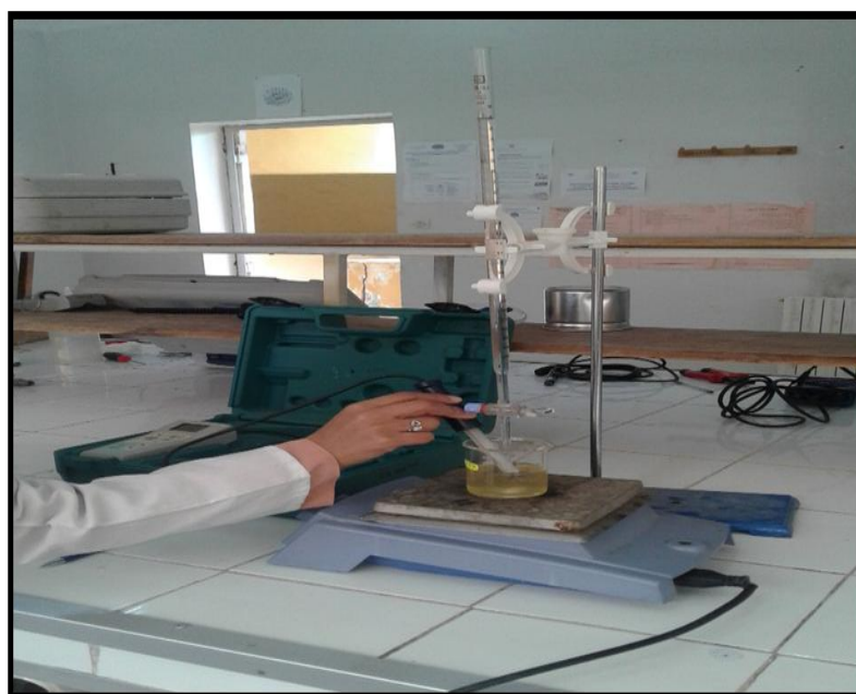
Figure 16 : Mesure de l'acidité libre d'échantillon jusqu'à le point d'équilibre.
