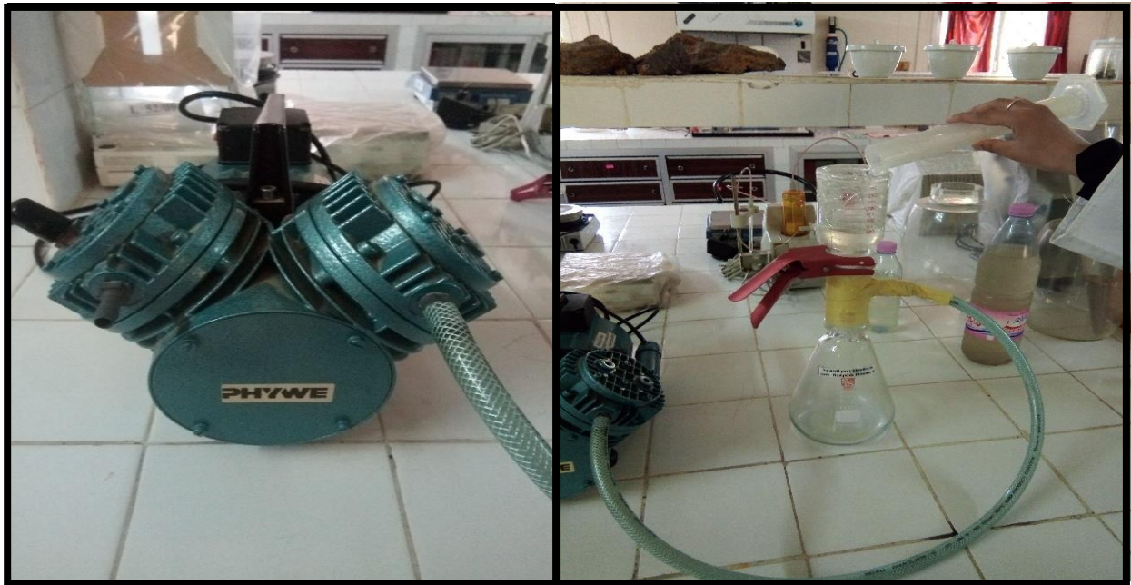
Photo 12: Rampe de filtration (appareil digestif MES) (17/04/2018)
