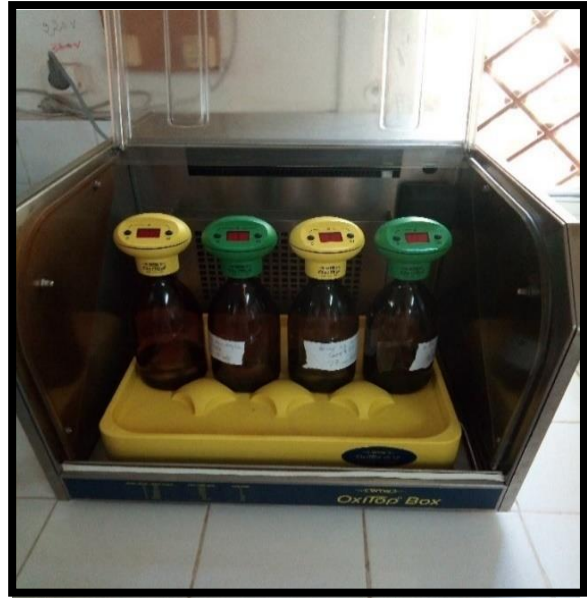
Photo 14: DBO mètre (OxiTop) (17/04/2018)
