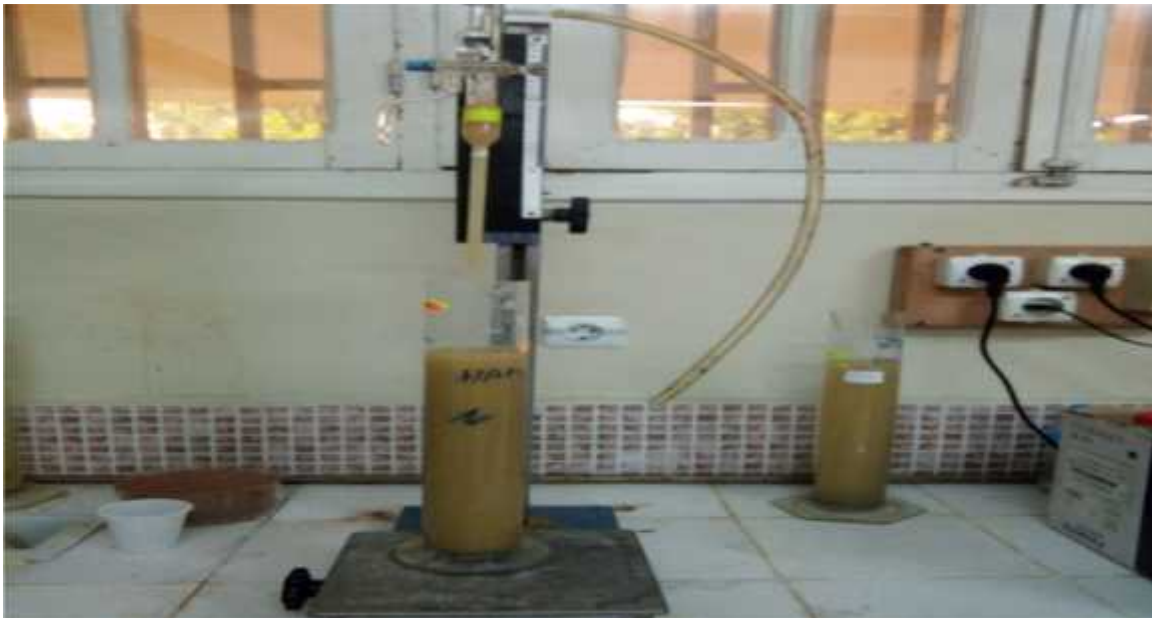
Figure n° 22: pipette de ROBINSON, et technique de prélèvement a pipette de ROBINSON, (Cliché korieb et Guettar, 2018).
