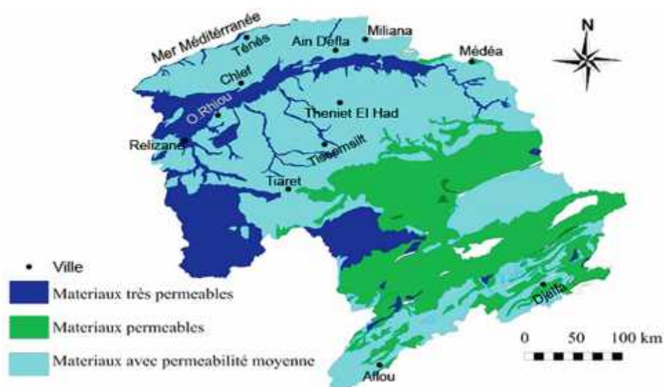
Figure n°15 : Répartition des matériaux géologiques des bassins du Chélif selon le degré de perméabilité (Source ABH Cheliff Zahrez).
