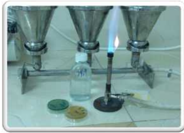
Photo 9 : Recherche des bactéries coliformes par filtration sur membrane (photo personnelle).
