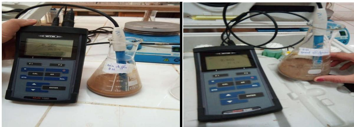
**Figure 10 :** Les photos de mesure du pH par un pH mètre électrique.
