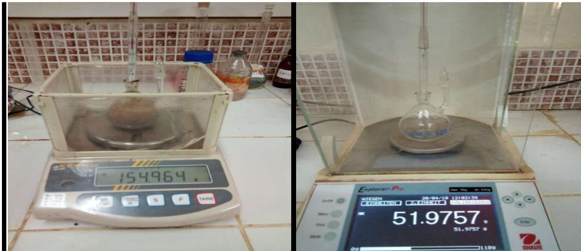
Figure 18 : Les photos de mesure de densité réelle par le pycnomètre.
