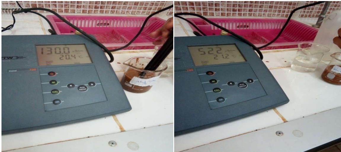
**Figure 13 :** Photos de mesure de la conductivité électrique d'une solution du sol.
