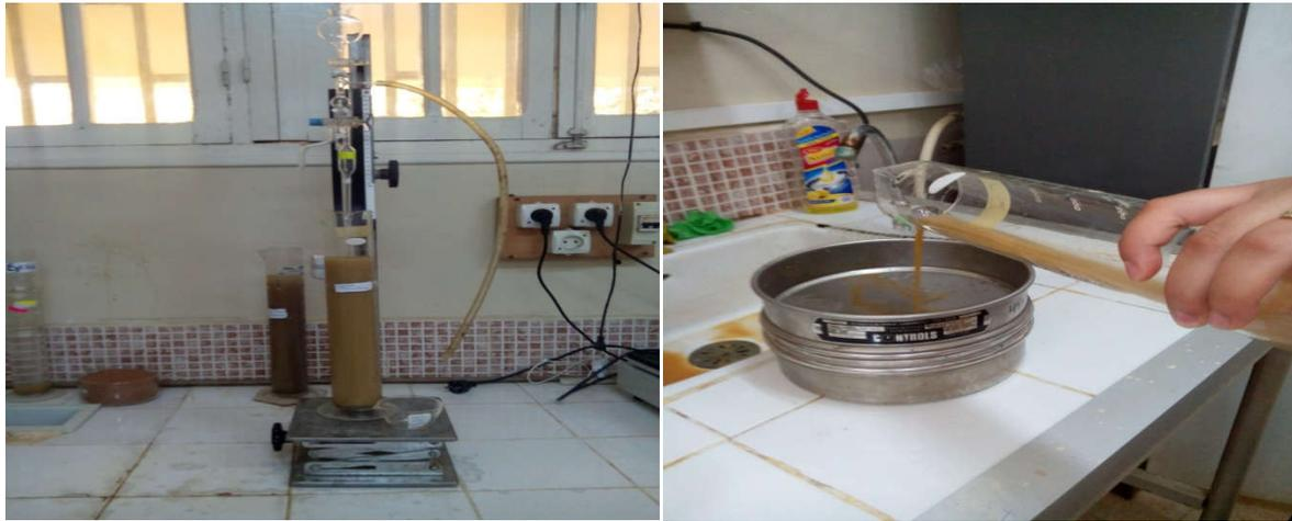
**Figure 11:** Photos d'analyse granulométrique.
