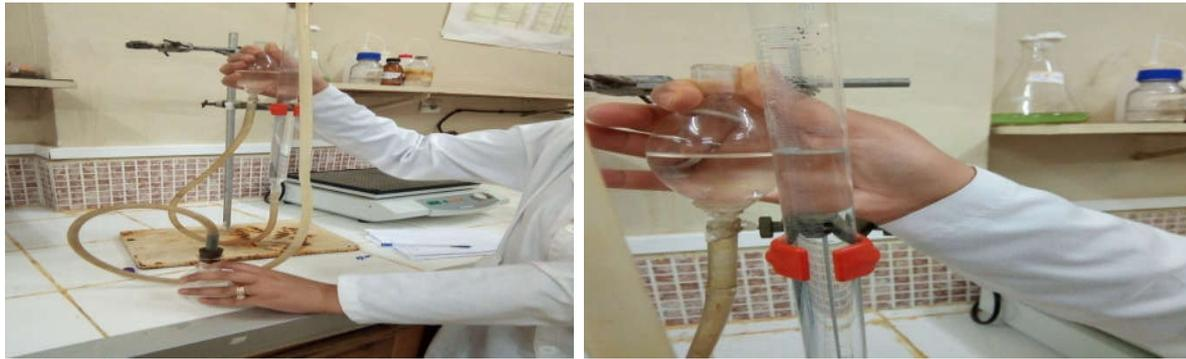
**Figure 15:** photos des analyses de  $\text{CaCO}_3$  du sol par le calcimètre de BERNARD.
