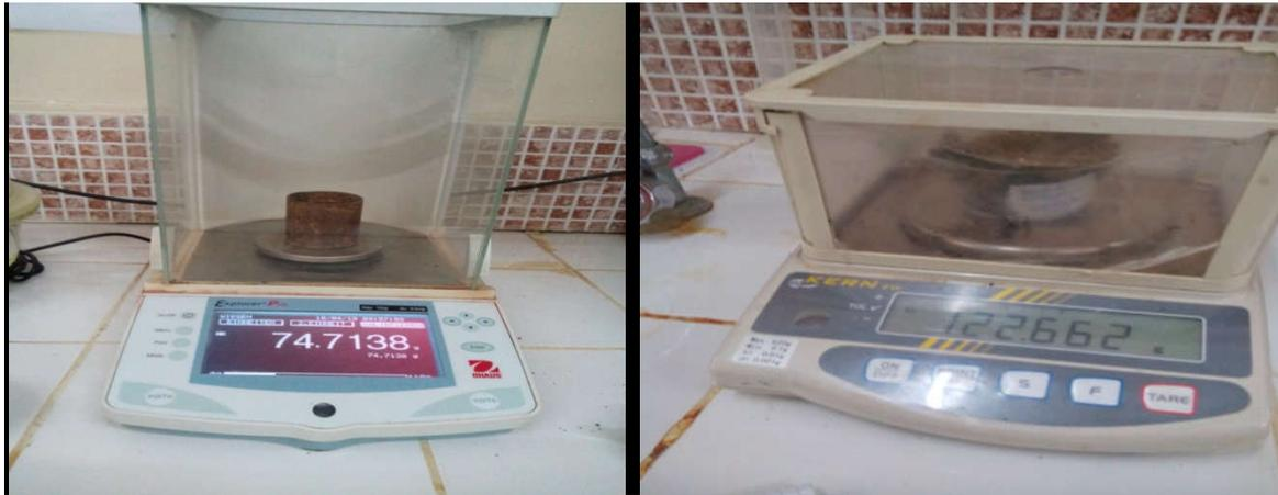
**Figure 17:** les photos de la mesure de densité apparente par le cylindre.
