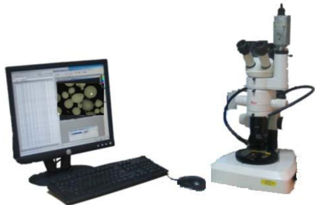
Figure 2.1: dispositif d'observation à partir du logiciel d'analyse d'images TSView (version 6.2.3.5).
