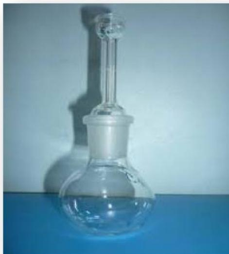
**Figure.1** : pycnomètre
