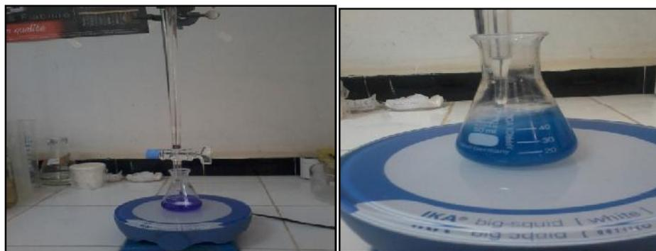
**Figure IV.7 :** Détermination d'indice d'oxirane de l'huile de tournesol epoxyde.
