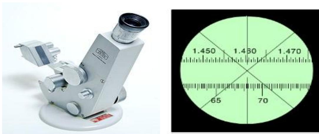
Figure IV.1 : Détermination de l'indice de réfraction de l'huile de tournesol[37].
