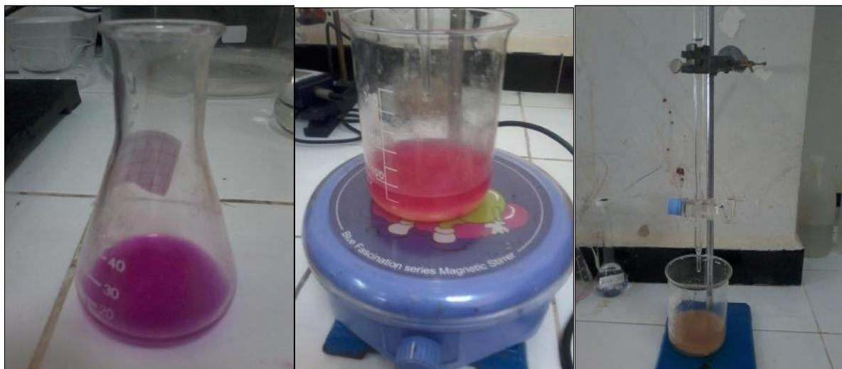
**Figure IV.4:** Détermination de l'indice de saponification de l'huile tournesol.
