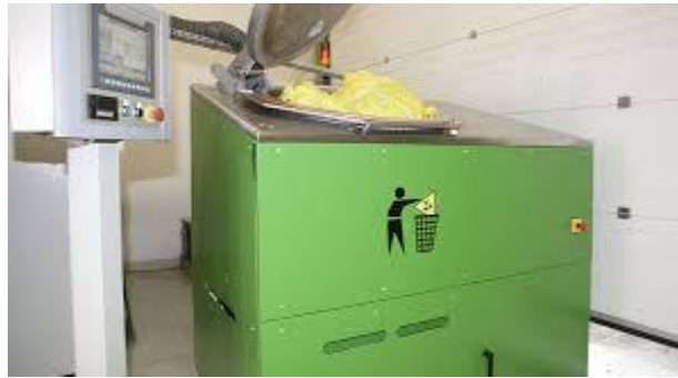
Figure III.1 : Le banaliseur existant au niveau de l'hôpital.
