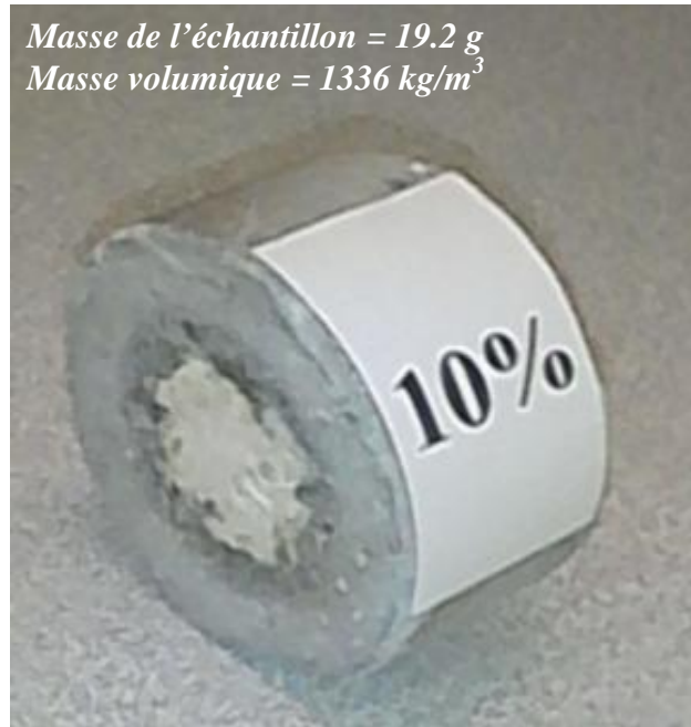
Figure.4.11 : Echantillon du composite plâtre / 10% fibre végétale.
