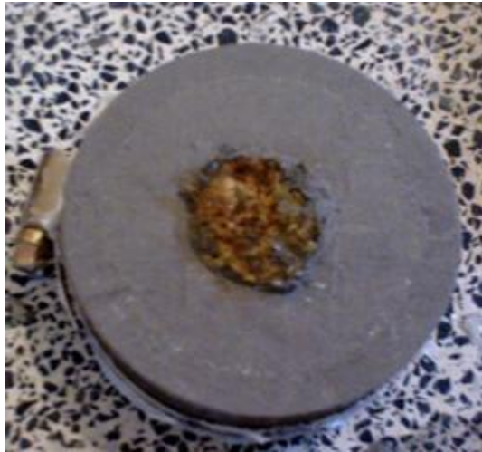
Figure.3.16 : Coulage du mortier isolant sur la surface radiale.
