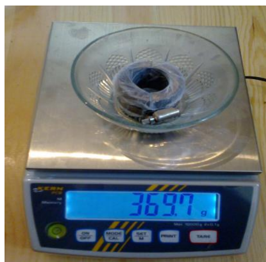
Figure.3.11 : Pesage de l'ensemble à vide (sans pâte).
