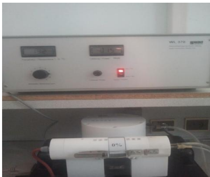
Figure.4.6 : Mise en place de l'échantillon 0% fibres sur l'unité WL370.
