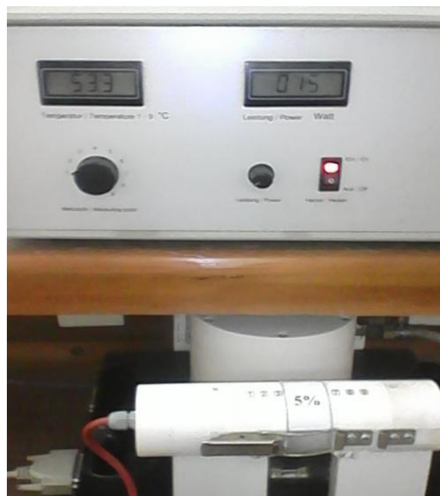
Figure.4.9 : Mise en place de l'échantillon 5% fibres sur l'unité WL370.
