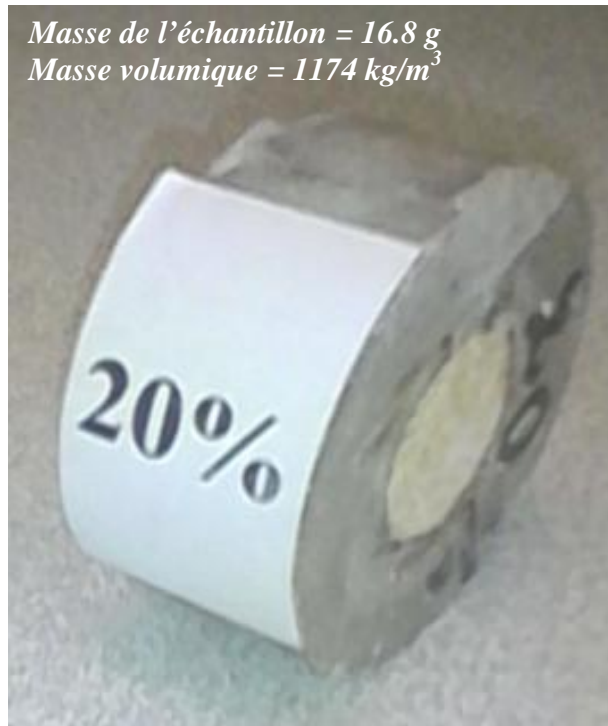
Figure.4.17 : Echantillon du composite plâtre / 20% fibre végétale.
