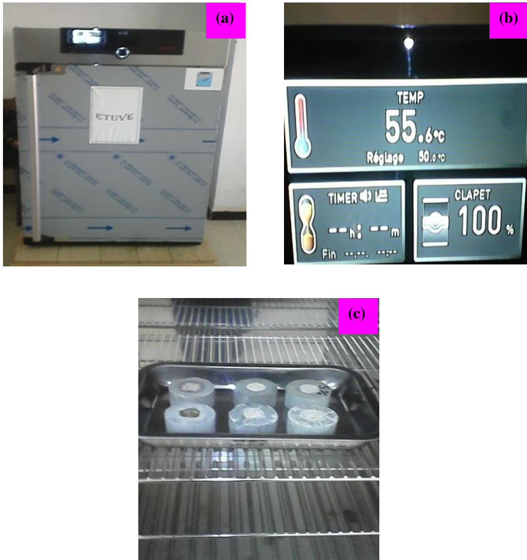
Figure.3.18 : Séchage des portes échantillons ; (a)- étuve, (b)- réglage de température, (c)- portes échantillons dans l'étuve.
