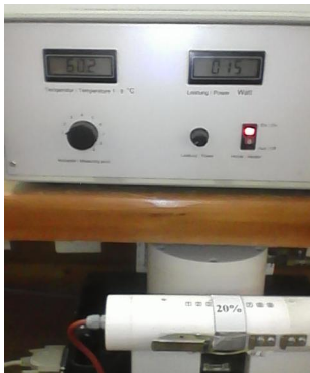
Figure.4.18 : Mise en place de l'échantillon 20 % fibres sur l'unité WL370.
