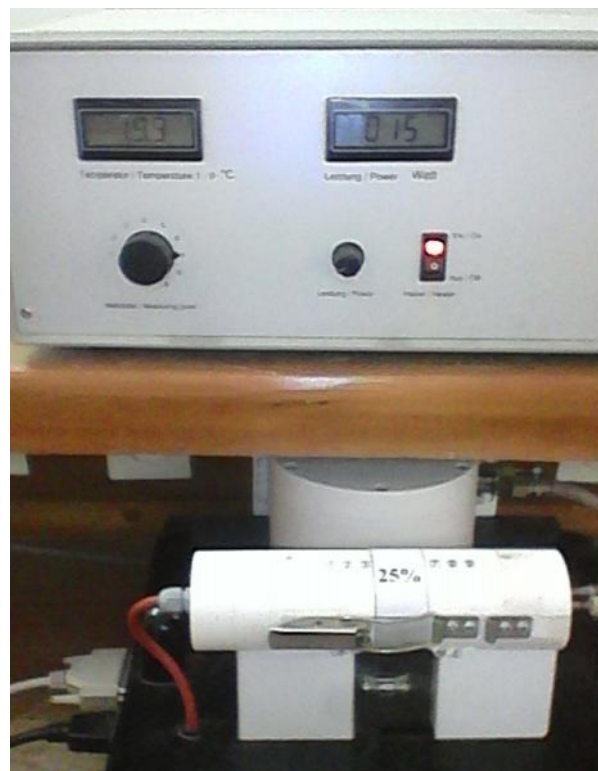
Figure.4.21 : Mise en place de l'échantillon 25 % fibres sur l'unité WL370.
