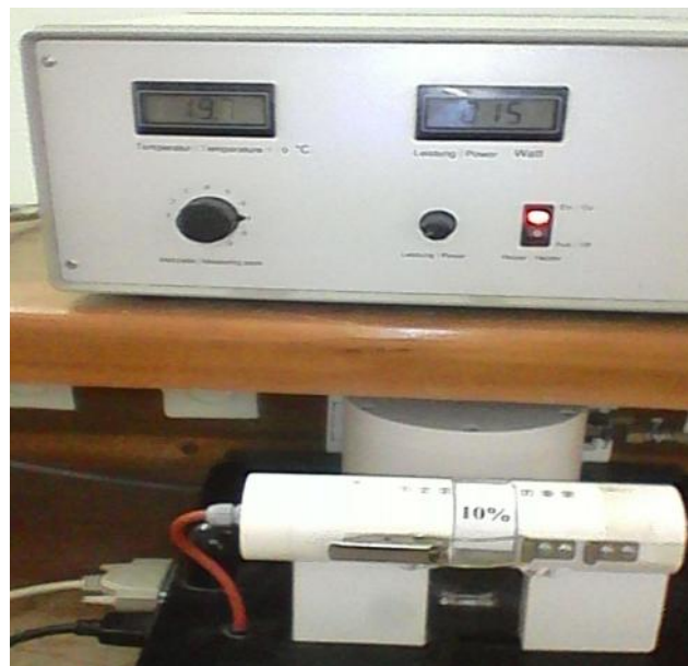
Figure.4.12 : Mise en place de l'échantillon 10% fibres sur l'unité WL370.
