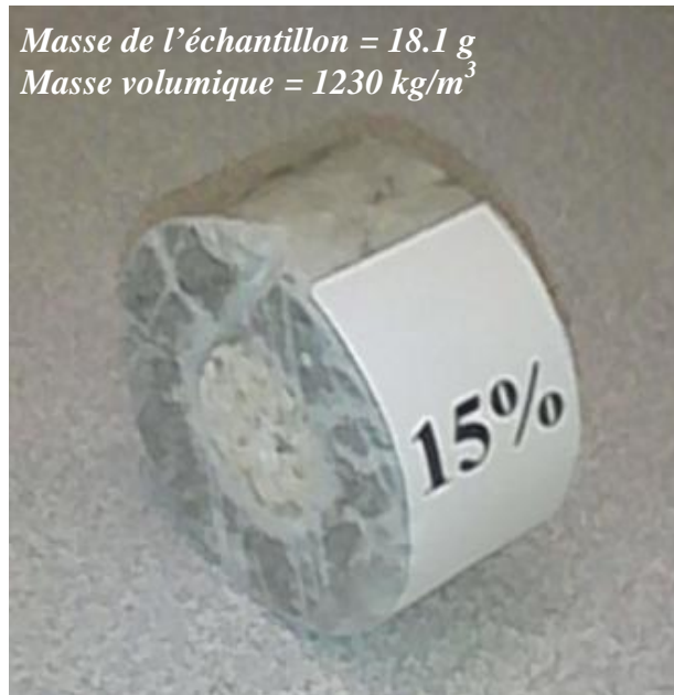
Figure.4.14 : Echantillon du composite plâtre / 15% fibre végétale.
