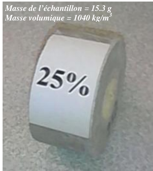
Figure.4.20 : Echantillon du composite plâtre / 25% fibre végétale.
