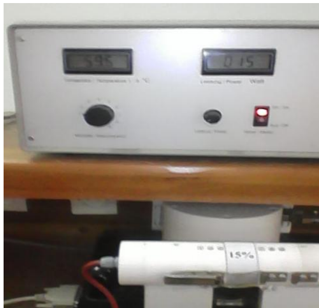
Figure.4.15 : Mise en place de l'échantillon 15% fibres sur l'unité WL370.
