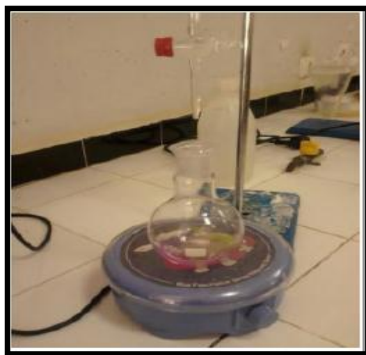
Figure II.8. Dispositif de titrage pour définir l'indice d'acide
