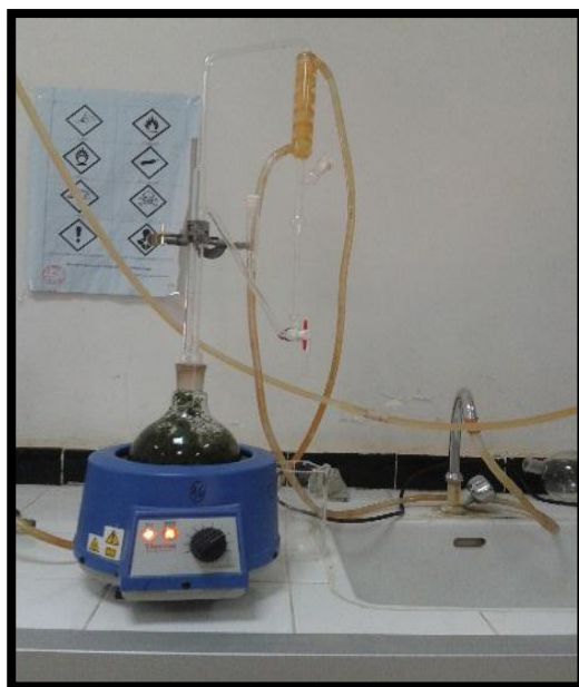
Figure. II.5 : Appareil de Clevenger pour l'hydrodistillation.
