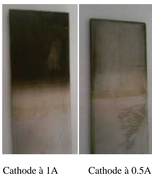
Figure IV.4. Cathode avec intensité de courant de 1A et autre de 0.5A
