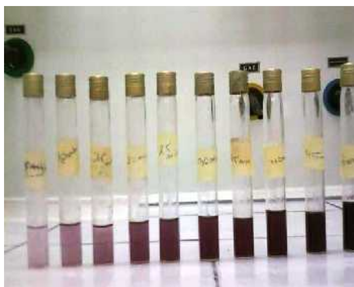
FigureIV. 1. Variation de la coloration au cours d'électrolyse
