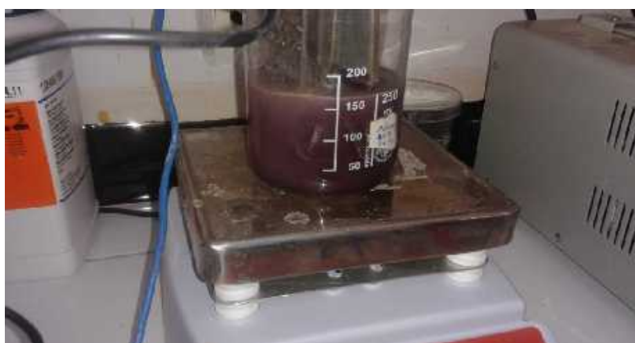
Figure IV.2 Solution des ferrates après 3h d'électrolyse
