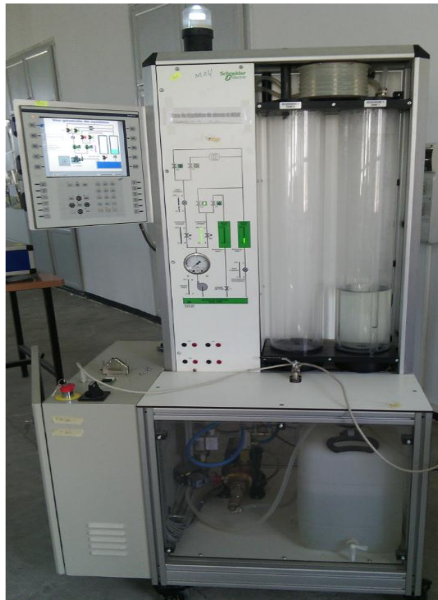
Figure.I.26. Vue réelle de l'unité régulation de débit et niveau d'eau.
