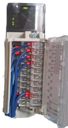
Figure I.21. Module sortie TOR TSX DSY 08R5
