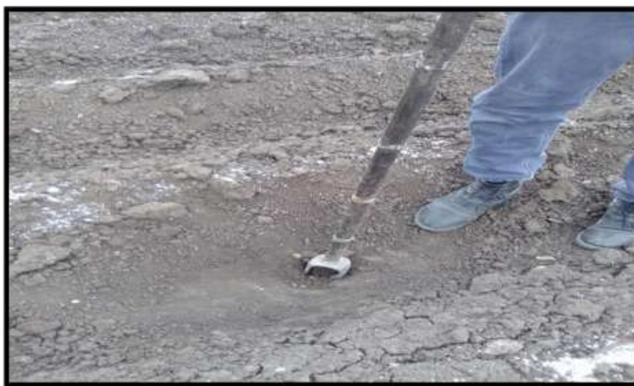
Photos n°3: Outil de prélèvement des échantillons de sol-Tarière (Djendel 2017).
