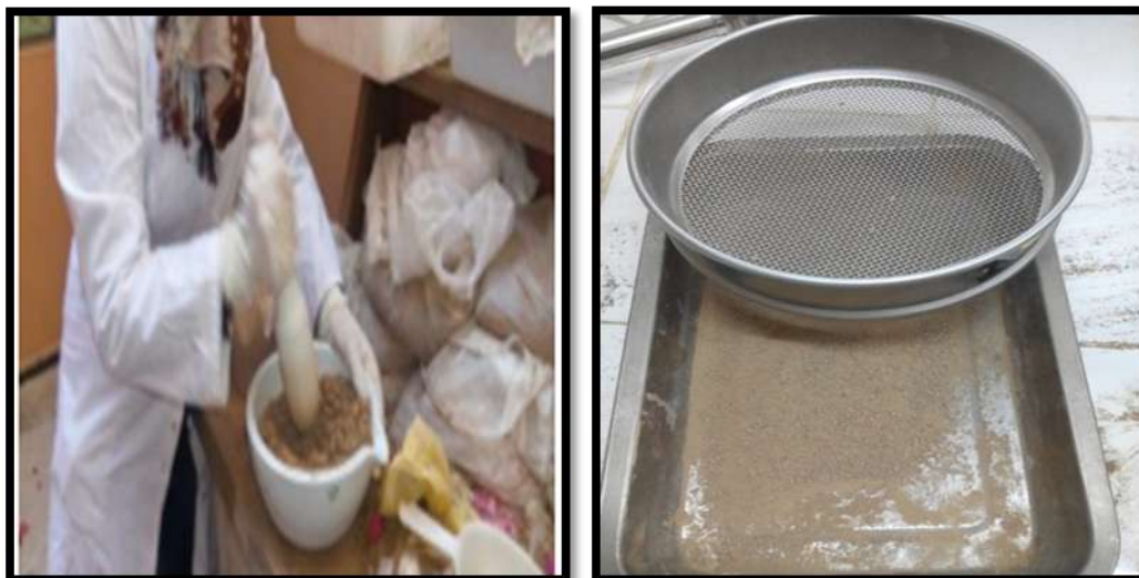
Photos n°8: broyage et tamisage des échantillons de sol à 2 mm.
