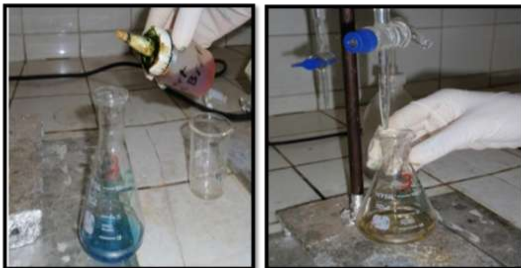
Photos n°13: l'ajout de l'indicateur coloré (Bromocrésol) (2017).
