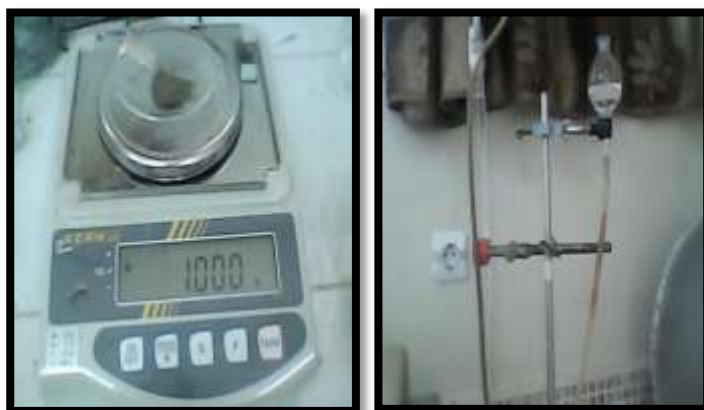
Photo n°08 : étapes de dosage de calcaire total.
