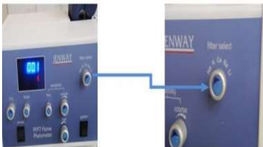
Photo n°14: le dosage du sodium et potassium par le photomètre à flamme.
