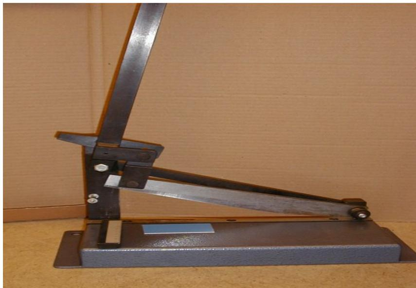
**Fig. V.9:** cisaille coupante.
