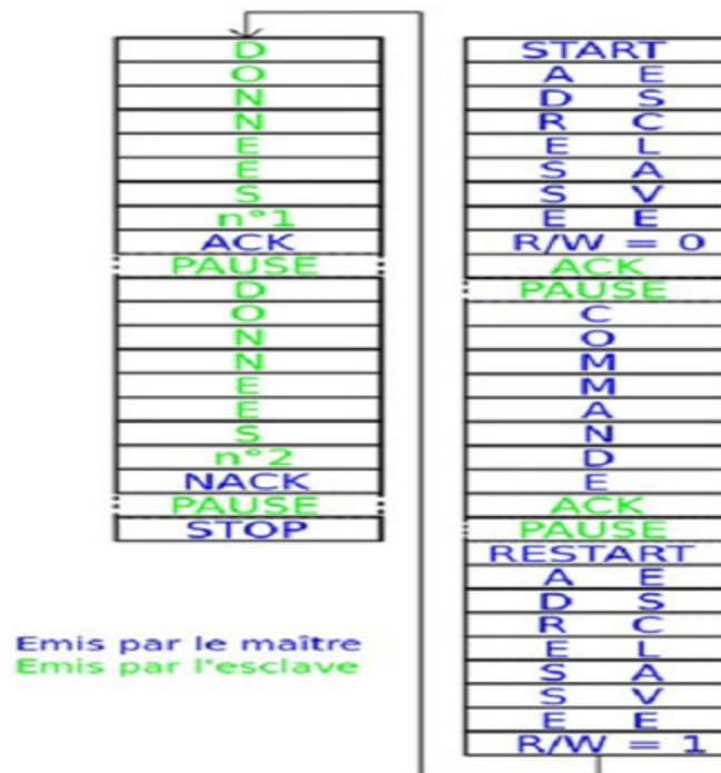
Fig. II.5: L'échange entre le maître et l'esclave.
