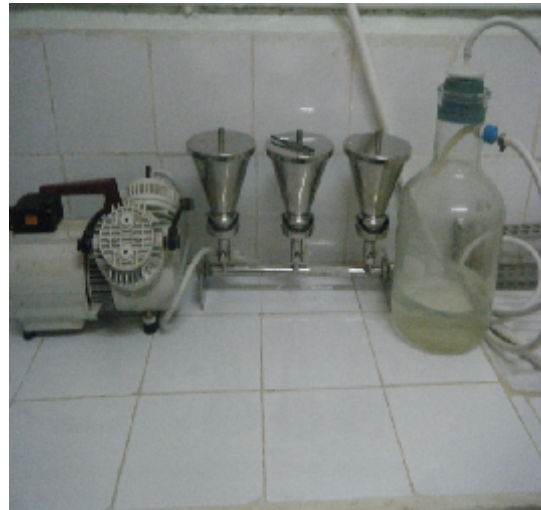
Rampe de filtration complète
