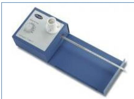
**Fig. IV.6 :** fusiomètre Analogique SMP11 Stuart [62].
