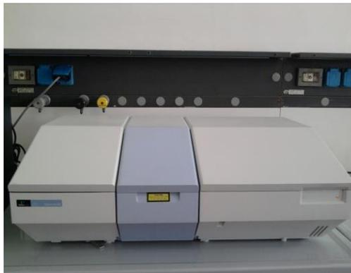
**Appareil d'un spectromètre FT-I**
