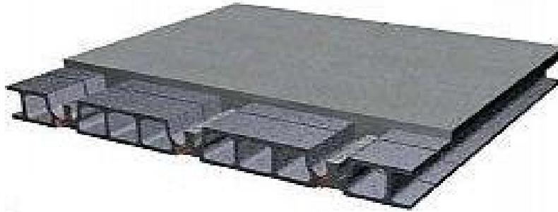
**Figure I.1 : plancher à corps creux.**
