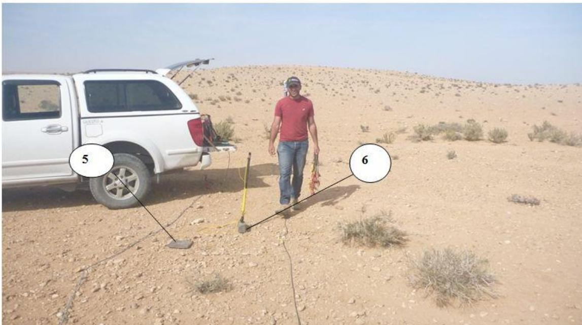
Figure 20. Source sismique utilisé durant l'acquisition.
