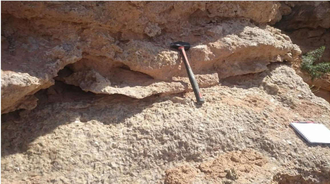
**Figure 6. Présence de gypse massif d'une dureté importante.**
