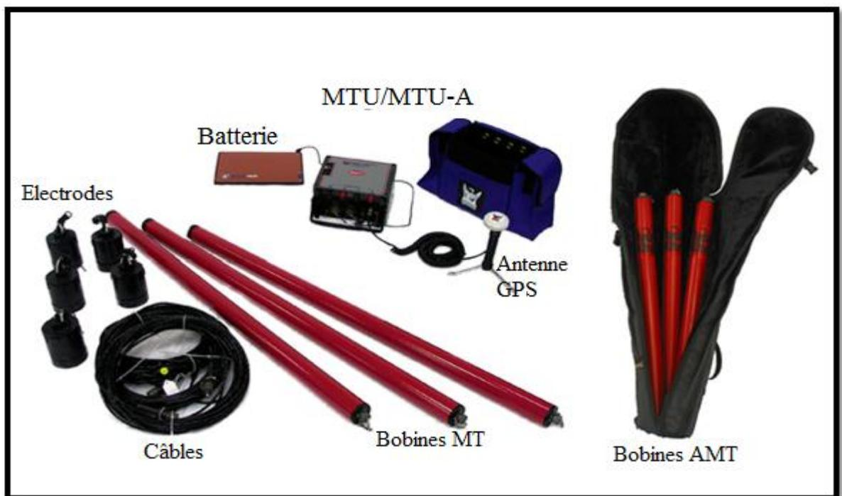
Figure III.2 : Figure représente le matériel utilisé pour l'acquisition des données MT.
