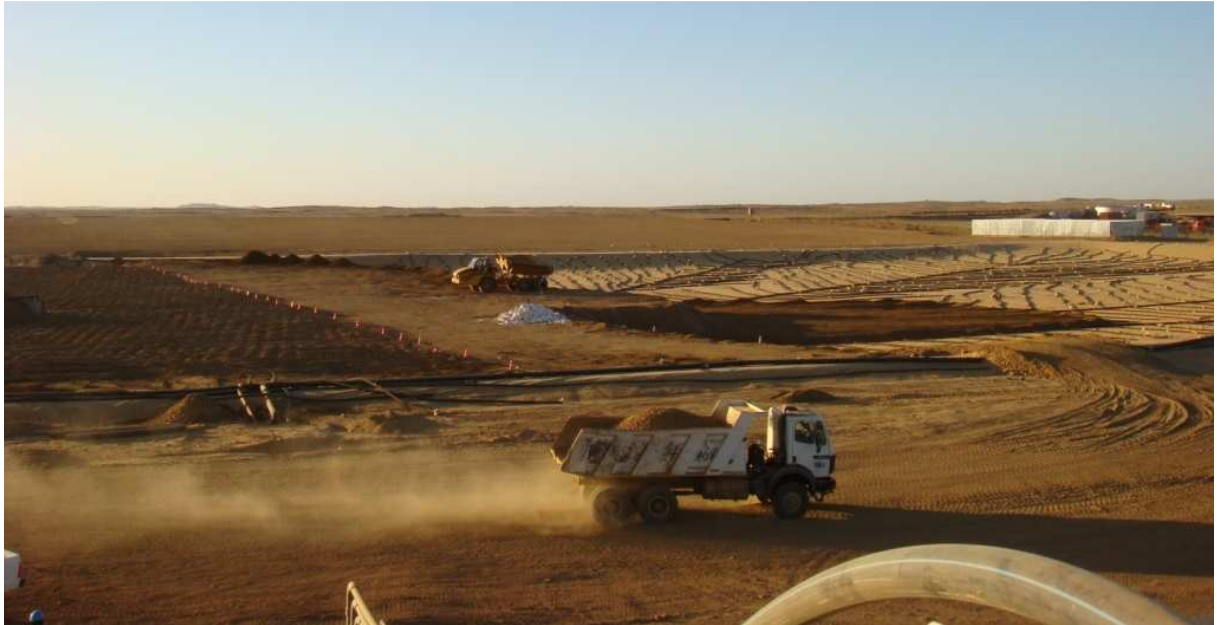
Figure. II.6 : début d'épandage du minerai à la première aire de lixiviation en tas à Amesmessa
