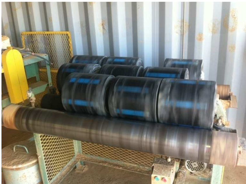
Figure.III.3: dispositif de rotation de bouteilles de cyanuration ( bottèle roller )
