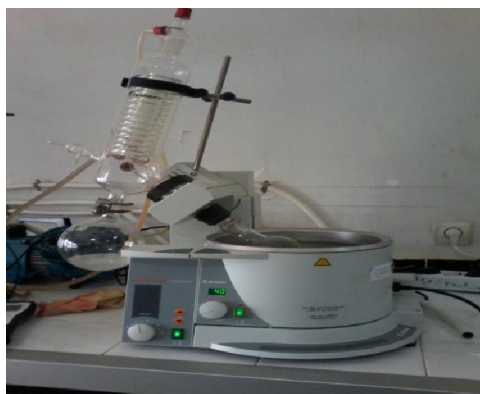
Figure III.5: Image photographique de l'étape de l'isolation (élimination du solvant) dans la rotavapeur
