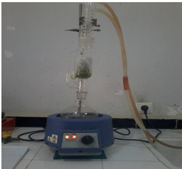
Figure.II.1. photo représentant l'appareil de soxhlet
