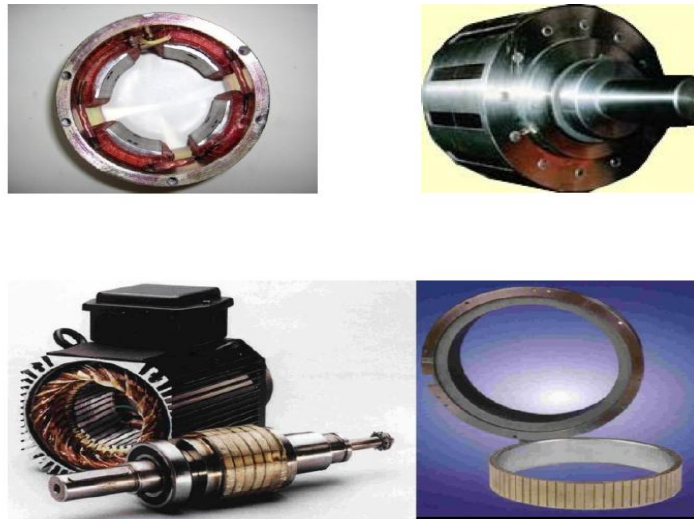
Figure 1 : Photographie de moteur à aimants en géométries cylindriques
