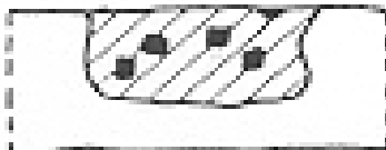
Figure. I. 8 : Corrosion et dissolution sélective
