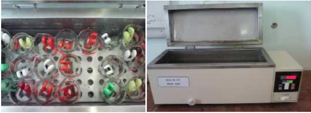
Figure. III.4. Photos représente les dispositif Expérimental de la technique de masse perdue
