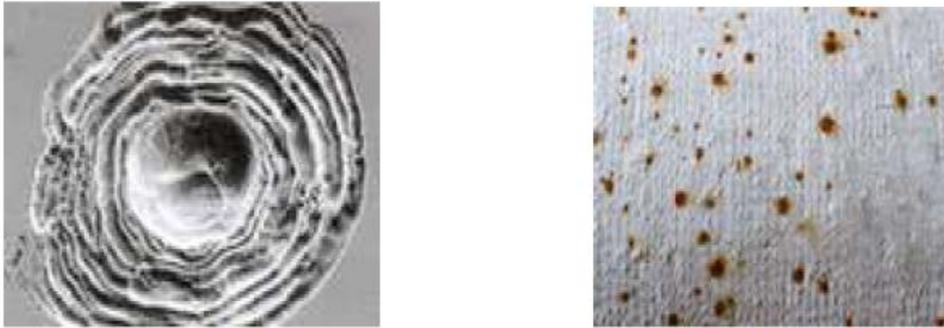
Figure I. 4: corrosion par piqûres
