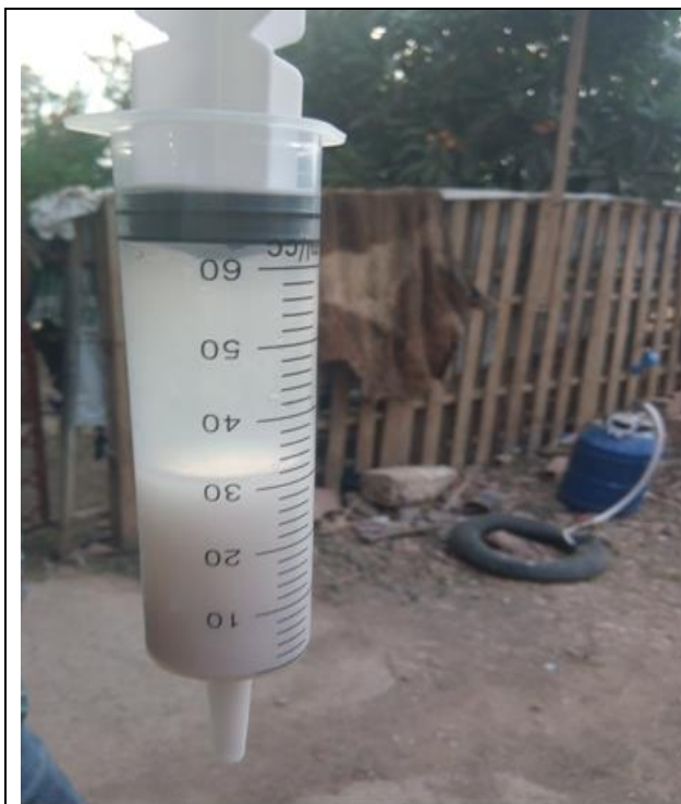
Figure IV-21 : Remplissage d'une seringue de 30 ml de biogaz est 30 ml d'eau de chaux
