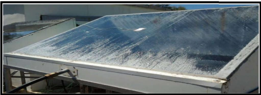
Figure 3.16 : vitrage installé sur le distillateur
