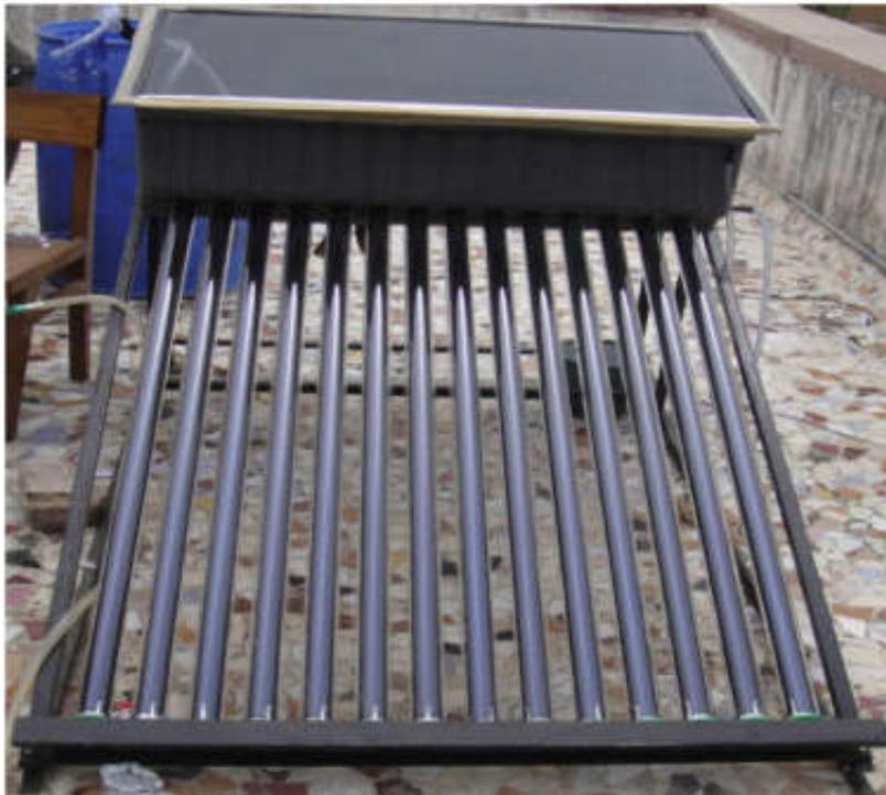
Figure 1.13: Distillateur solaire d'un double bassin avec des tubes vide [25].
