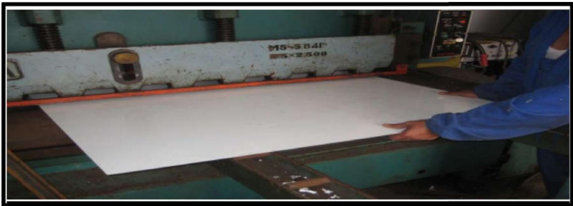
Figure 3.5 : Etape de réalisation (découpage)[34].
