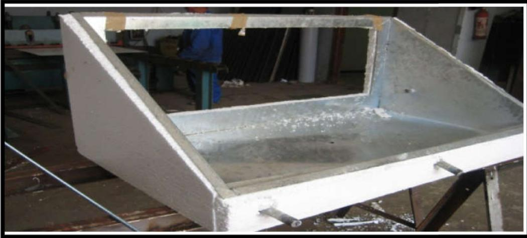
Figure 3.12 : Etape de réalisation du bassin (isolation)[34].
