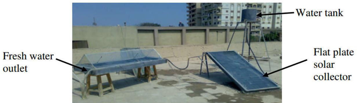
Figure 1.12: Distillateur solaire à double pente avec un collecteur solaire [24].
