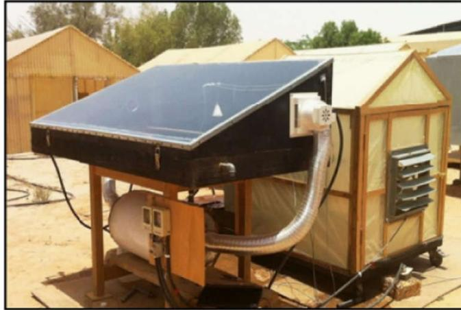
Figure 1.17 : Distillateur solaire couplé à un condenseur[29].
