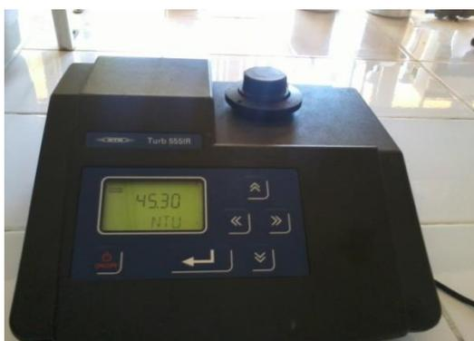
Figure 2. Turbidimètre
