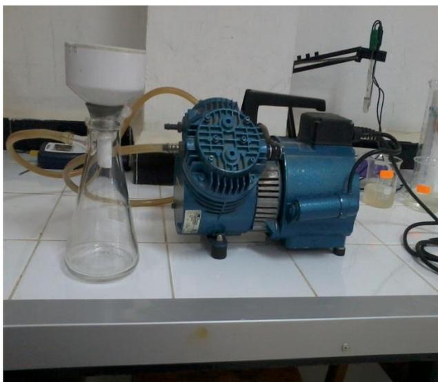
**Figure 6.** Montage de Matière en Suspension
