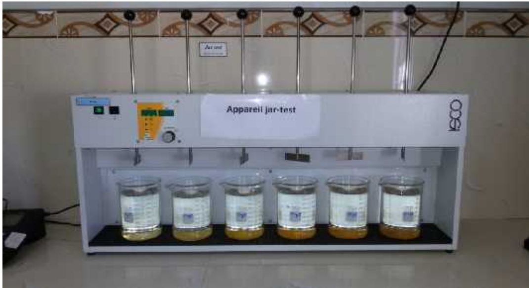
Figure IV.3 : L'eau de barrage après 30 minutes de décantation par le coagulant (FeCl 3 ).
