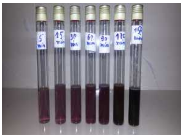
Figure III.1 : Variation de la coloration de la solution des ferrates au cours de l'électrolyse.
