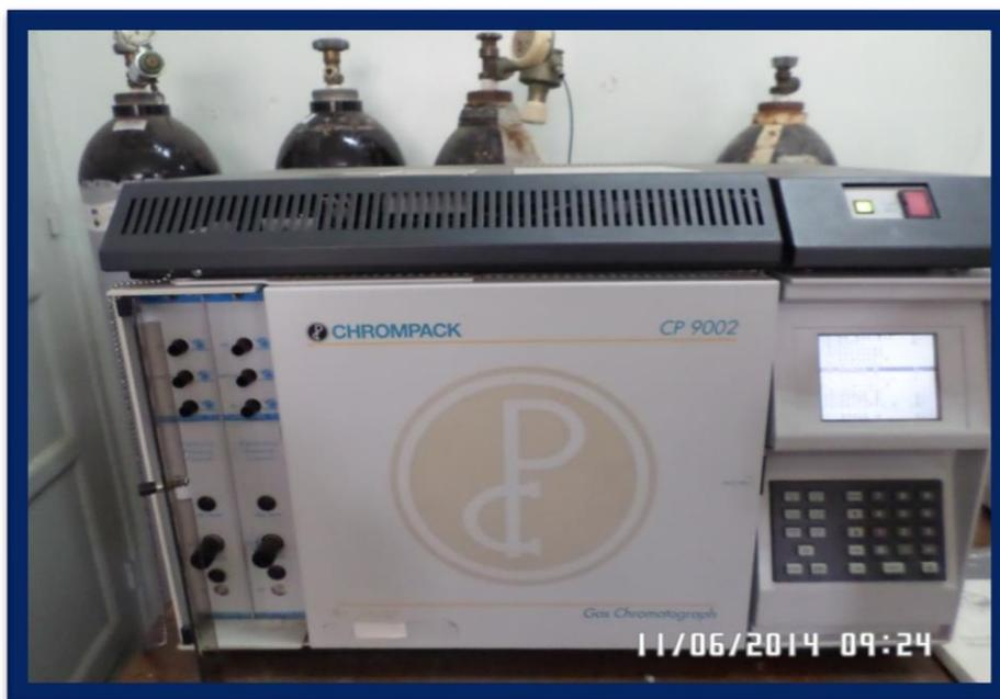
**Figure 3 :** Appareil de CPG.
