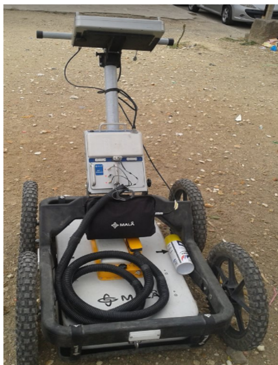
Figure 18: Photo du GeoRadar : antenne 250 MHz dans le chariot.
