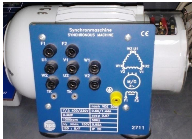
Figure 2-11 : moteur synchrone pour les essais des courbes de Mordey.
