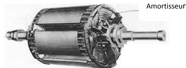
Figure 1-9 : Rotor d'une MS avec amortisseurs [06]
