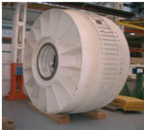
Figure II.16 : Machine à flux axial ou discoïde [06].
