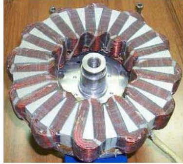
Fig.II.10 : Bobinage concentré pour machine à flux axial [16].
