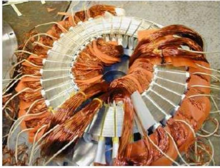
Fig.II.9 : Bobinage réparti pour machine à flux axial [16].
