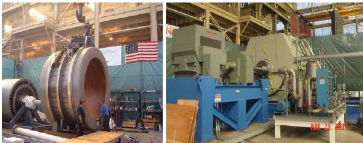
Figure II.14 : Moteur HTc de propulsion de navire 36,5 MW construit par AMSC [19]
