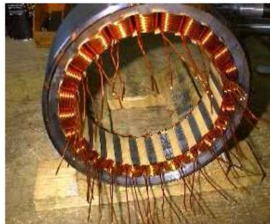
Fig.II.7 : Bobinage concentré pour machine à flux radial. [16]
