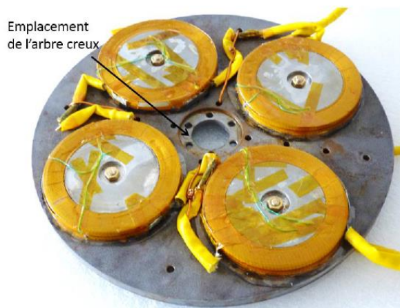
FigII.30 : Inducteur supraconducteur avec des bobines doubles couches dans l'entrefer du moteur [01]
