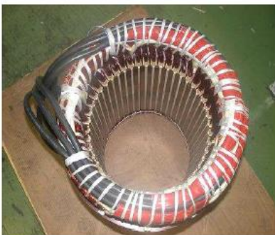
Fig. II.6 : Bobinage réparti pour machine à flux radial.[16]
