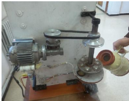
Figure (III.22) : Refroidissement de la machine par l'azote liquide verticalement.
