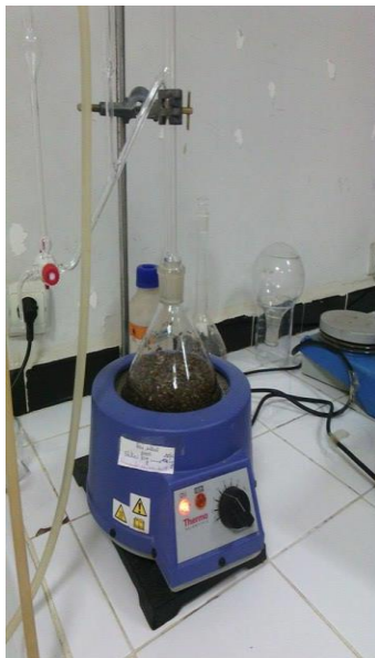
Appareil de Clevenger pour l'hydro distillation
