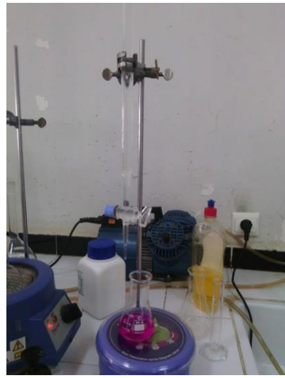
Dispositif de titrage pour définir l'indice d'acide
