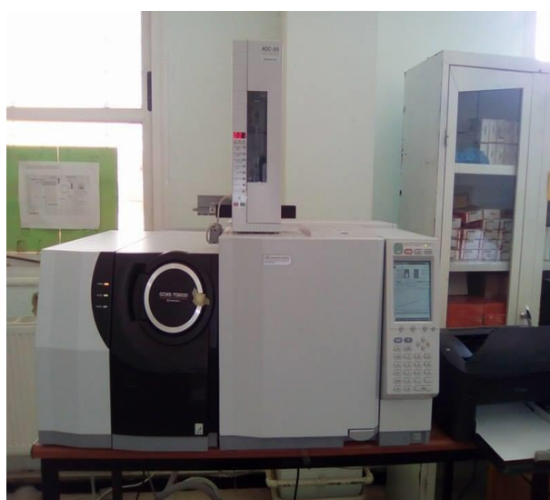
Figure 2.11 chromatographie en phase gazeuse couplé à la spectrométrie de masse (CGMS)
