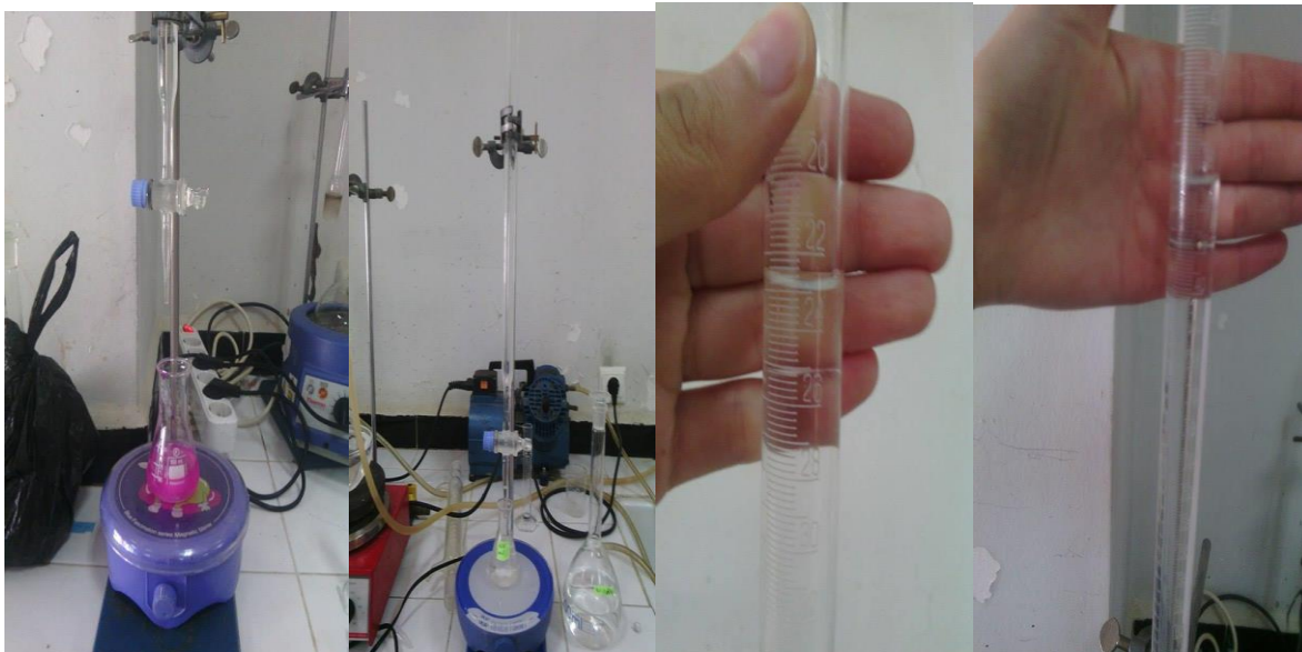
figure 2.10 : Dispositif de titrage pour définir l'indice d'ester
