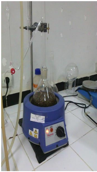
Figure 2.3 : Appareil de Clevenger pour l'hydro distillation
