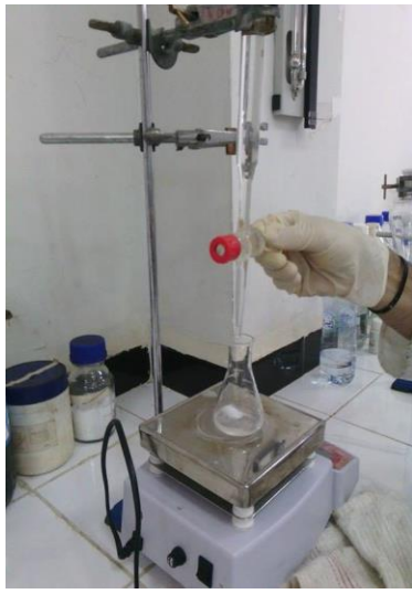
Dispositif de titrage pour définir l'indice d'acide
