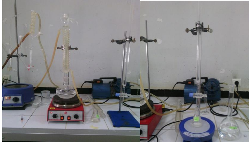
Montage de mesure de l'indice ester.
