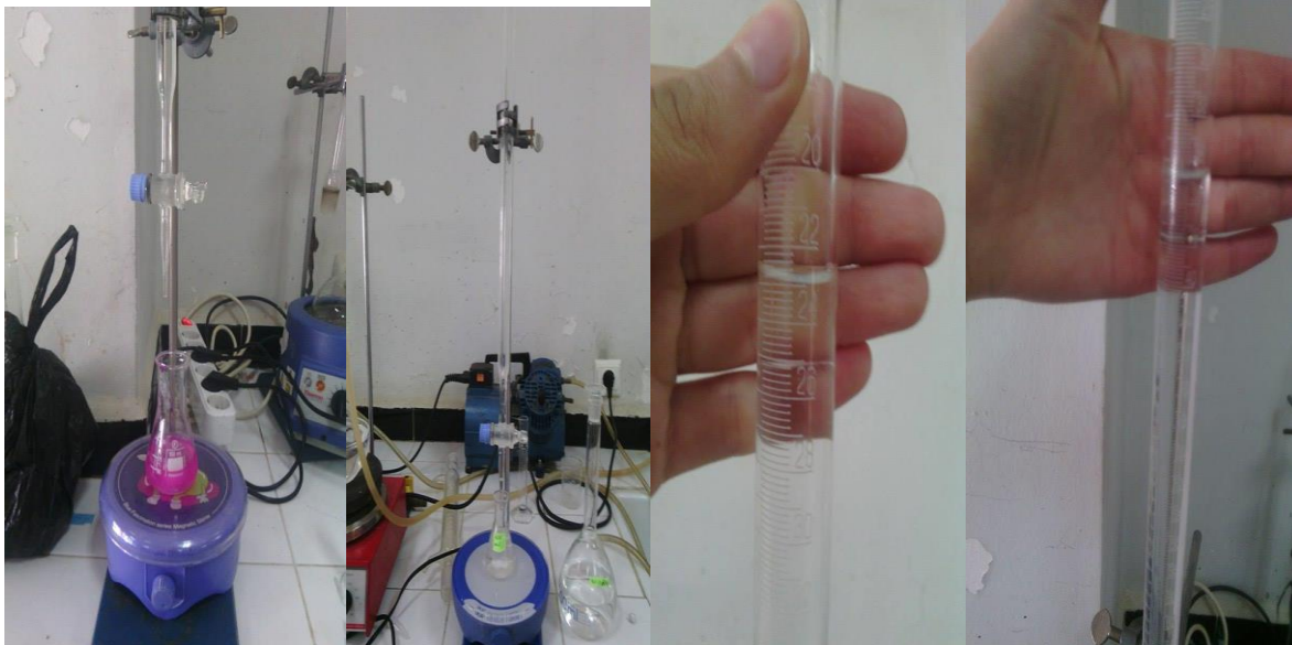
Dispositif de titrage pour définir l'indice d'ester
