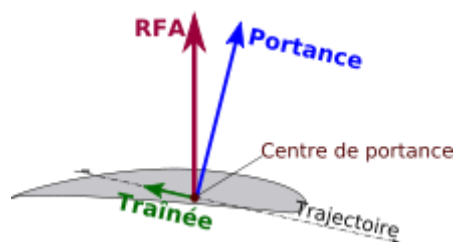
Figure I.14. Portance et traînée sur un profil.
