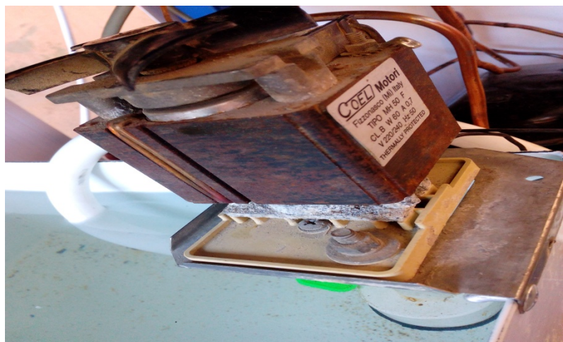
Figure 4.10 : La pompe immergée 50 l/min
