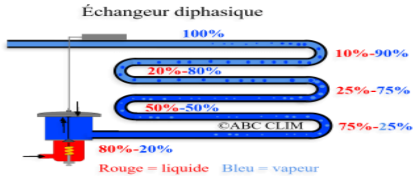
Figure 3.3 : Echangeur diphasique (source ABC Clim)
