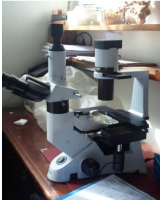
Figure 8 : Photos d'un microscope photonique inversé type OPTIKA B 500 (Originale).
