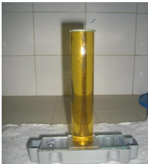
Figure 9 : Photos de la cuve de sédimentation avec la chambre de sédimentation (Originale).
