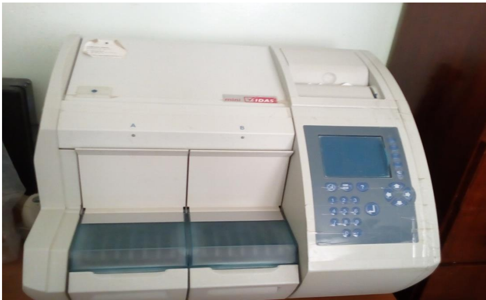
Figure 8 : Automate hormonale de famille mini VIDAS pour le dosage de la vitamine D
