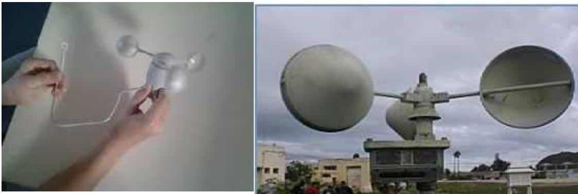
Figure 02 : photo de L'anémomètre (Source : LADLANI, 2006).
