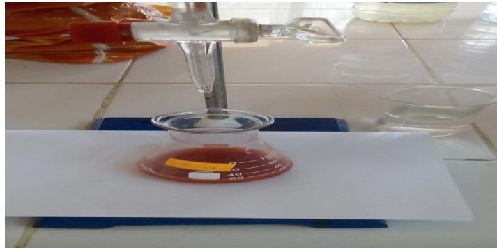
Figure 7 : Résultat de titrage de chlorure (virage rouge brique).
