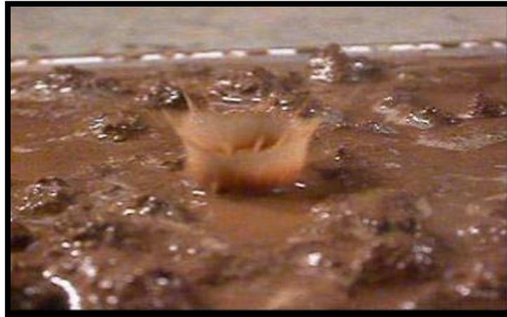
**Figure 1:** Rejaillissement du sol et de l'eau suite à l'impact d'une goutte d'eau, ou effet splash (Leguédois, 2003)
