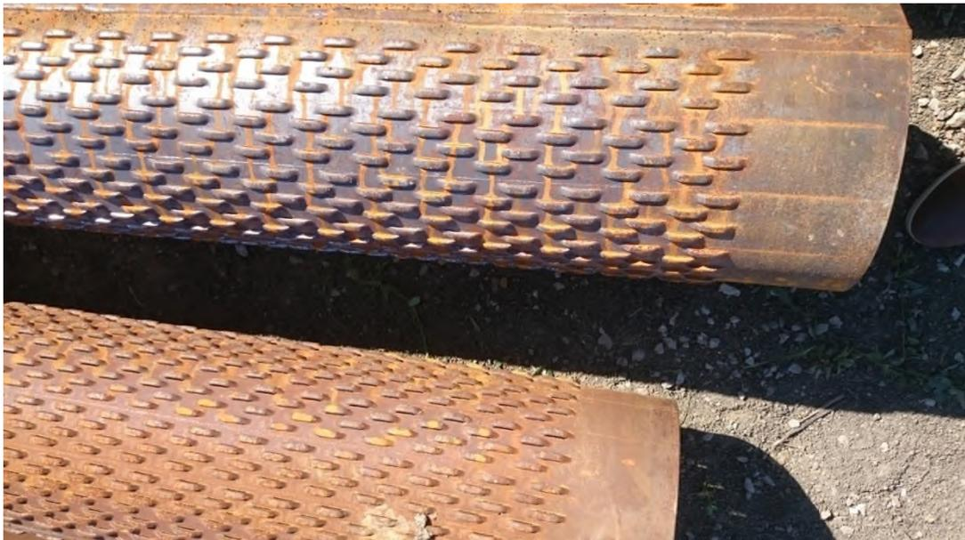
Photo N°08. Photos montrant les crépines de type nervure repoussée.
