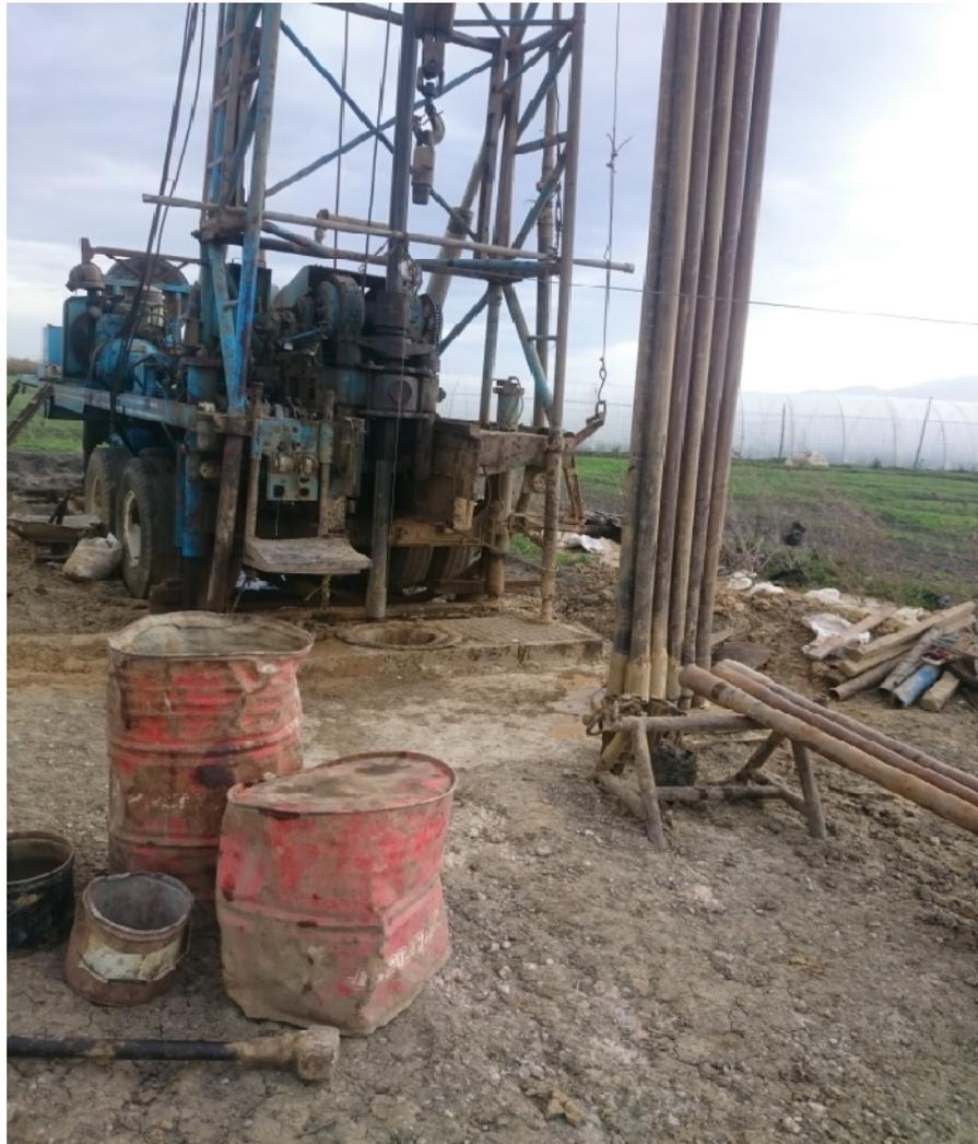
Photo N°01 : Appareille de forage « méthode rotary » utilisée dans le chantier
