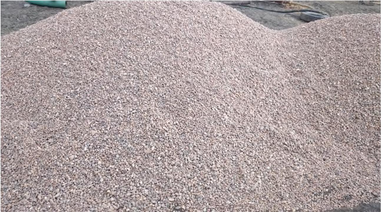
Photo N°09 le massif de gravier utilisé est siliceux à éléments arrondis.
