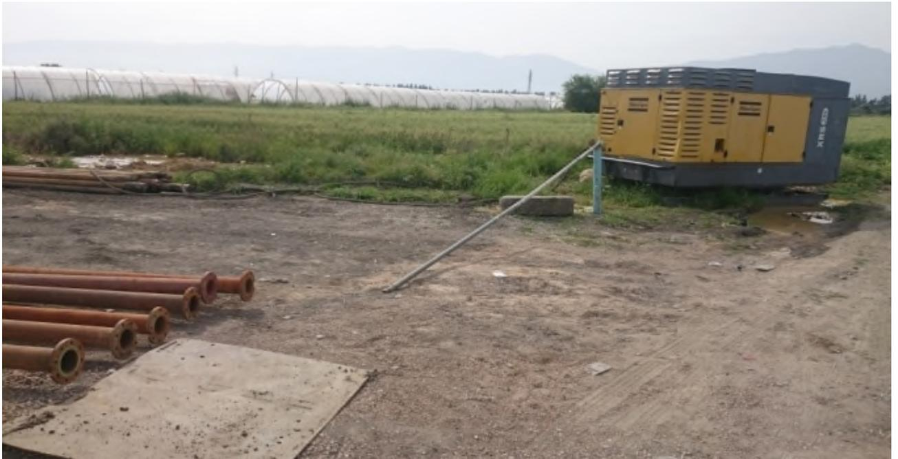
Photo N°13 : Compresseur d'air (32 bars) utilisé.
