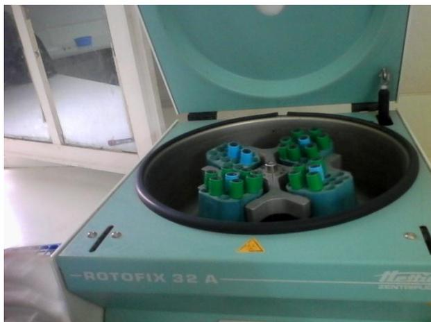
**Figure 23:** centrifugeuse
