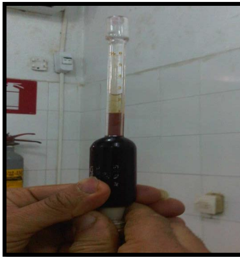
Photo 6 : Mesure de la teneur en matière grasse à l'aide d'un butyromètre
