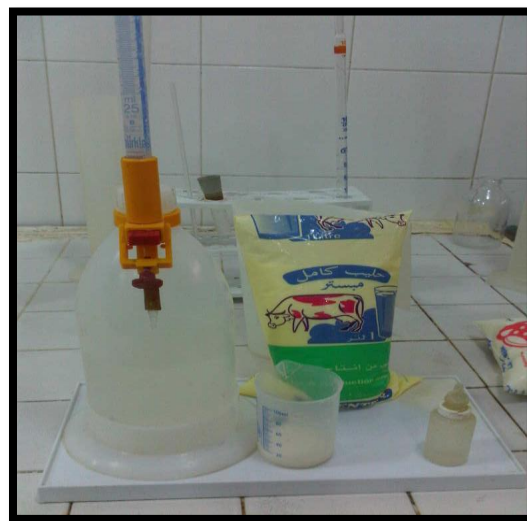
Photo7: Mesure d'Acidité titrable en °D pour le lait de vache entier
