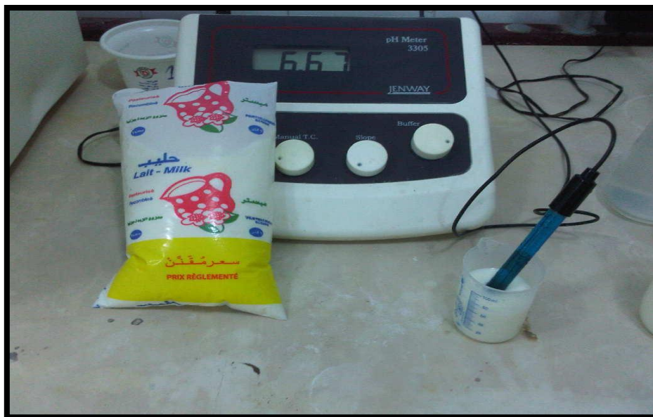
Figure 2: Mesure du pH par un pH Mètre
