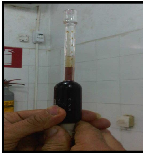
Photo 5 : Mesure de la teneur en matière grasse a l'aide d'un butyromètre
