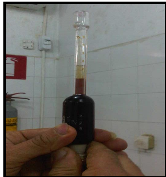
Photo 5 : Mesure de la teneur en matière grasse à l'aide d'un butyromètre
