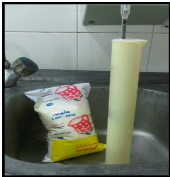
Photo3 : Mesure de la densité du lait
