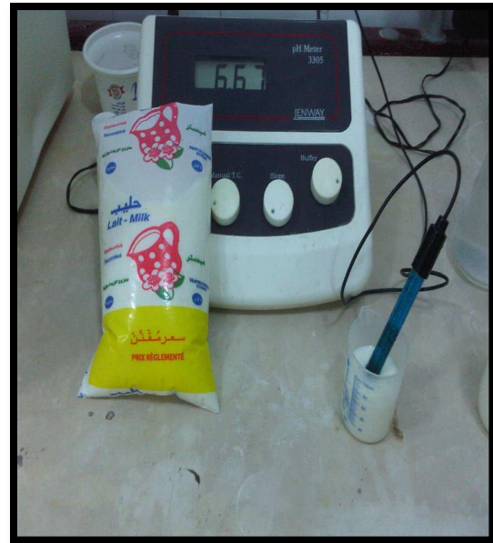
Photo 2 : Mesure du pH par un pH Mètre
