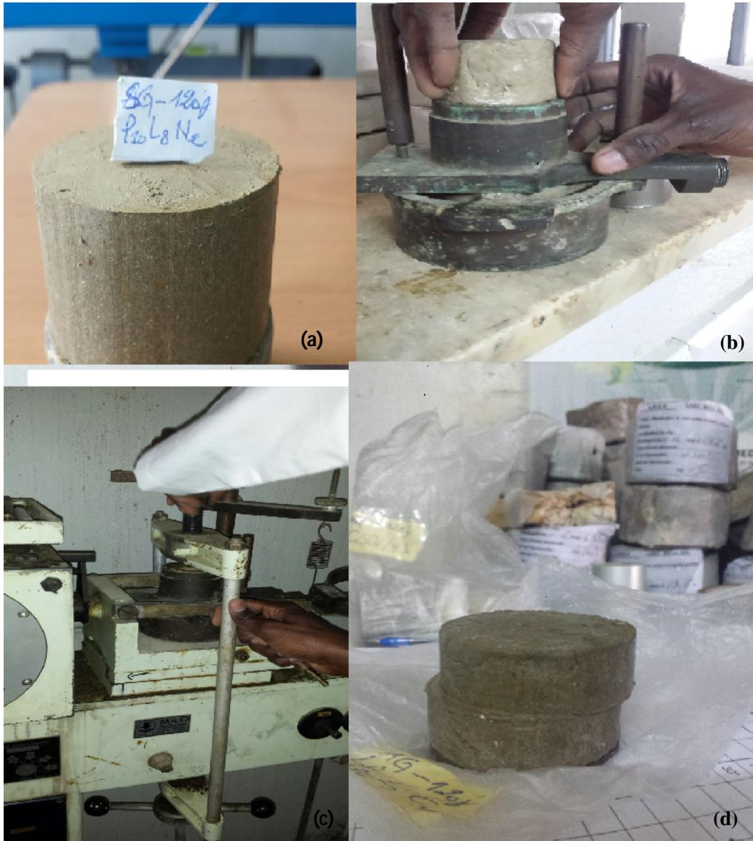
**Fig. 4.13** : Procédure de cisaillement. (a) : éprouvette à cisailier, (b) : installation de l'éprouvette dans la boîte de cisaillement, (c) : installation de la boîte dans la machine de cisaillement, (d) : éprouvette après cisaillement
