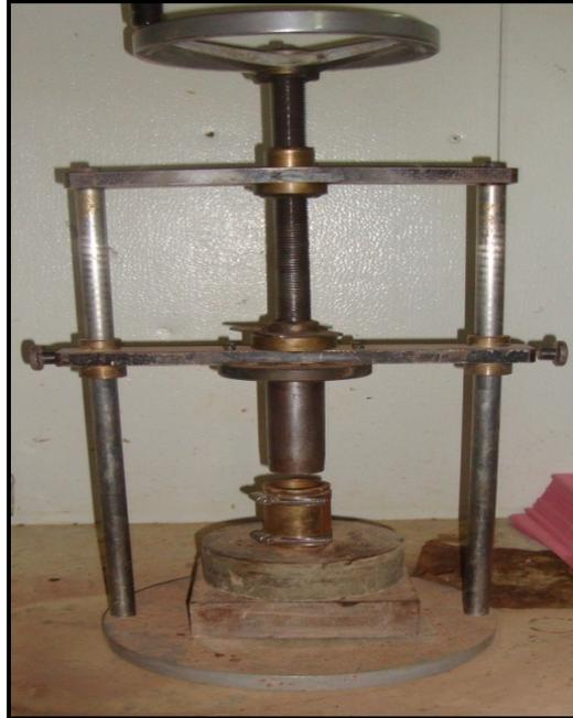
**Fig. 4.11** : Presse statique manuelle destinée à la confection des éprouvettes et moule cylindrique
