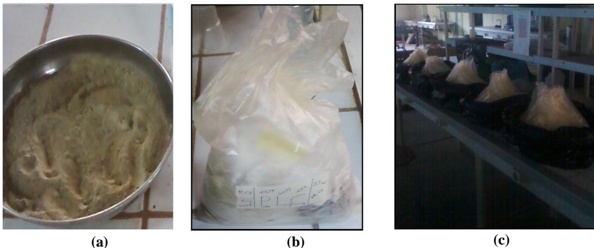
**Fig. 4.9 :** Différentes étapes de la préparation des échantillons. (a) malaxage et homogénéisation à sec après pesage, (b) : conservation dans des sacs hermétique, (c) : stockage dans un endroit sec.
